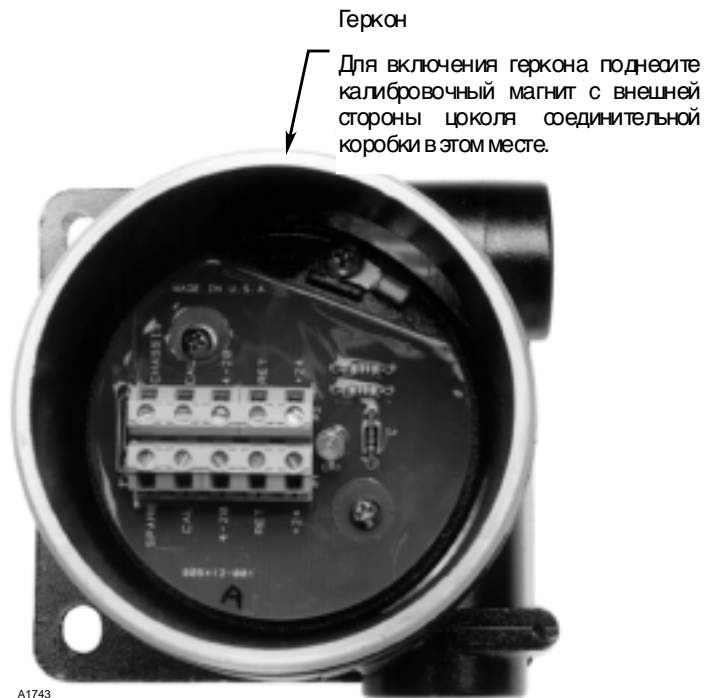
Рис. 16. Расположение клеммных контактов и геркона в соединительной коробке.
