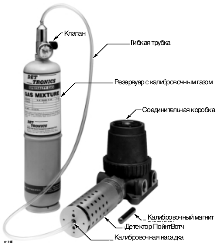
Рис. 22. Конфигурация детектора ПойнтВотч в алюминиевом корпусе для процедуры калибрования.
