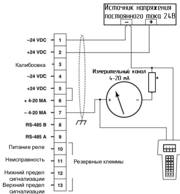
Рис.8. Газоанализатор ТГА в схеме с неизолированным выходом 4-20 мА (источник тока).
