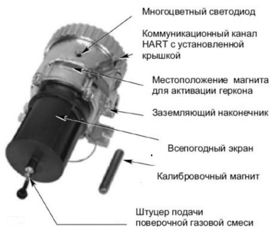
Рис. 21. Газоанализатор со снятым всепогодным экраном.
