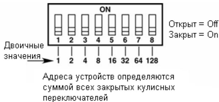
Рис. В-1. Адресные переключатели газоанализатора ТГА
