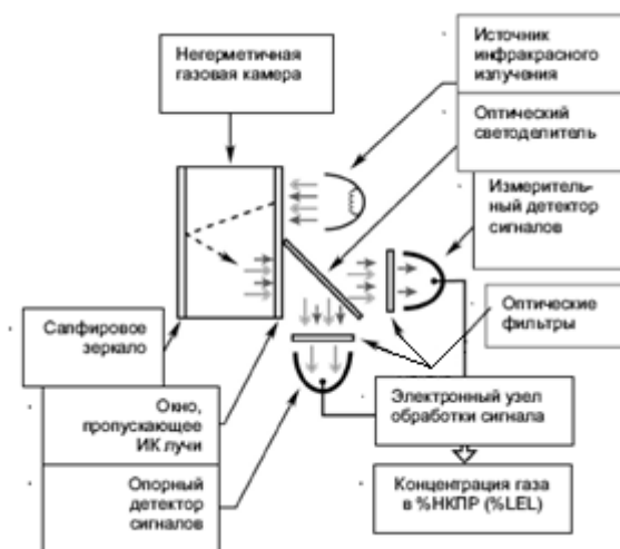
Рис. 3 – Схема измерения газоанализатора инфракрасного диапазона, функциональная.
