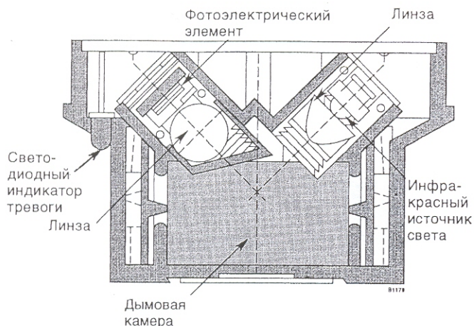
Рис.1. Конструкция извещателя (в разрезе).
