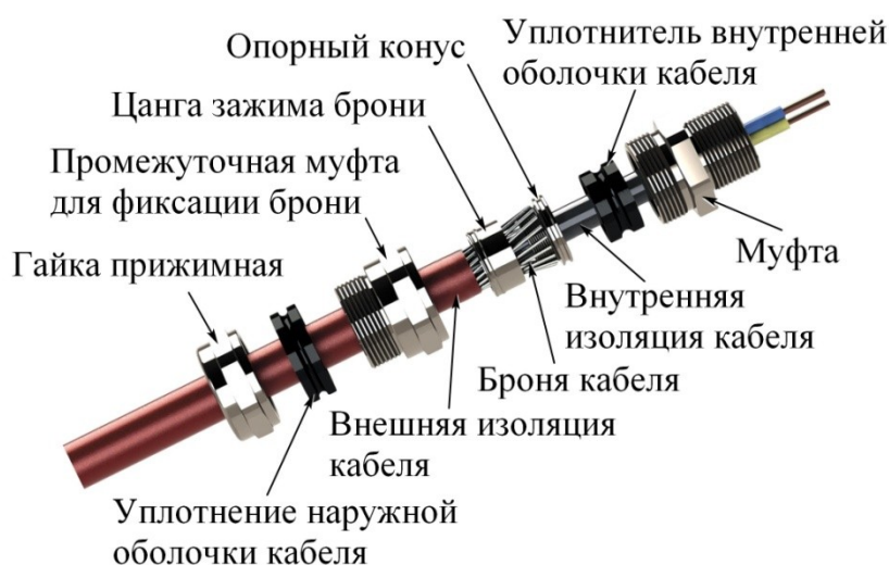
Рисунок 8 – Пример монтажа кабельного ввода
