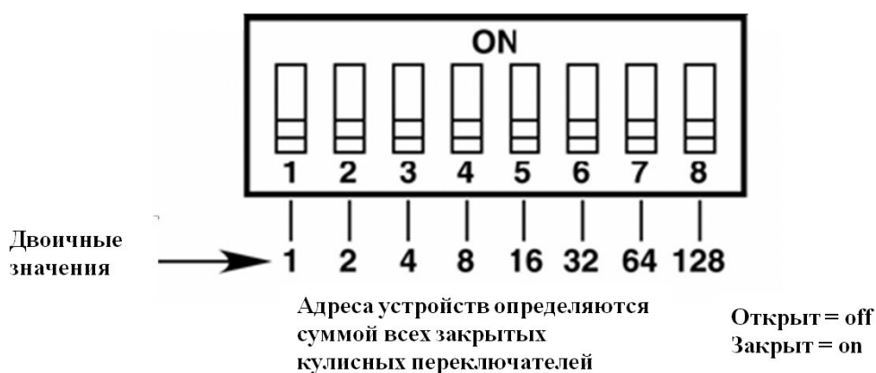
Рисунок 18 – Адресные переключатели извещателя
