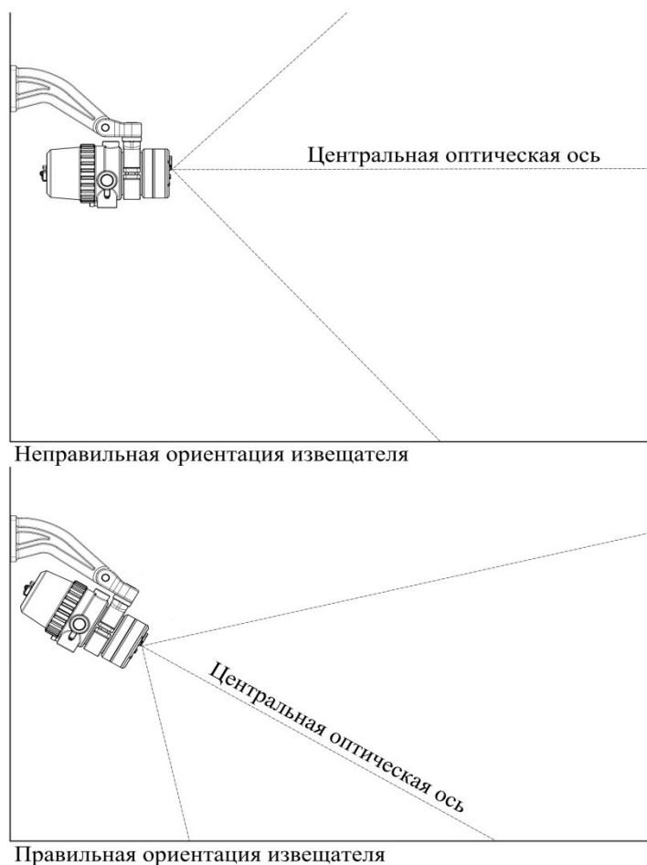
Рисунок 6 – Установка извещателя по отношению к горизонту.
