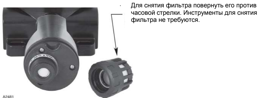
Рис. 15. Газоанализатор GT3000 со снятым сменным фильтром.
