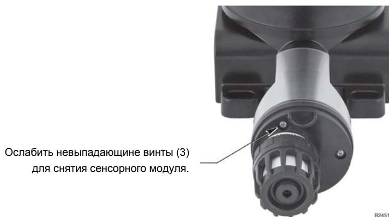
Рис. 16. Месторасположение винтов для смены сенсорного модуля.
